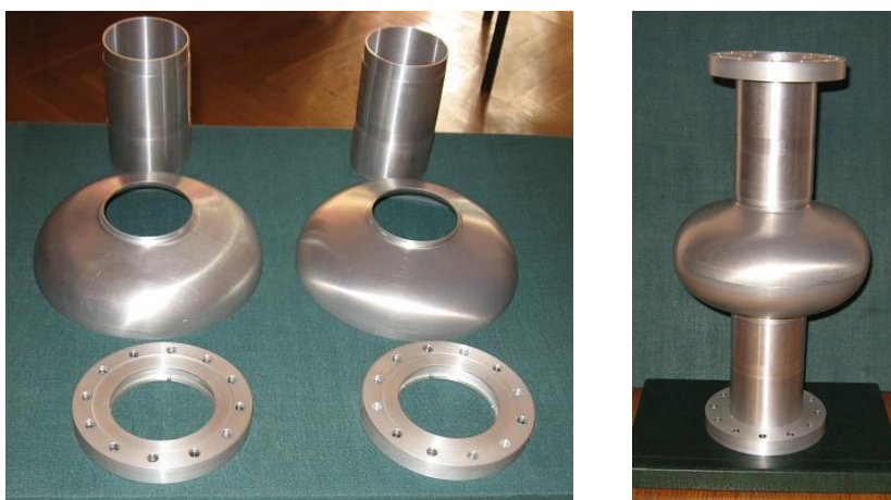
Рисунок 2: Изготовленные детали одноячеечного резонатора из ниобия (слева) и резонатор в сборе (справа)
